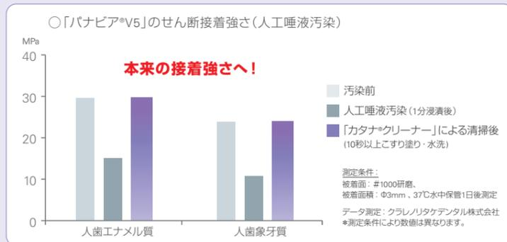
測定条件: 被着面: #1000研磨、被着面積: Φ3mm、37℃水中保管1日後測定
