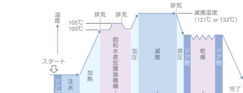
最初に100℃で水を沸騰させて発生する水蒸気で残留空気を追い出します。そのまま105℃まで加圧し再度空気を抜きを行うことで、噴出する水蒸気の力でさらに残留空気を追い出しチャンバー内を飽和水蒸気に置き換えます。
