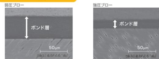
強圧でのエアブローでは、弱圧でのエアブローよりボンド層の厚みは薄くなる。
