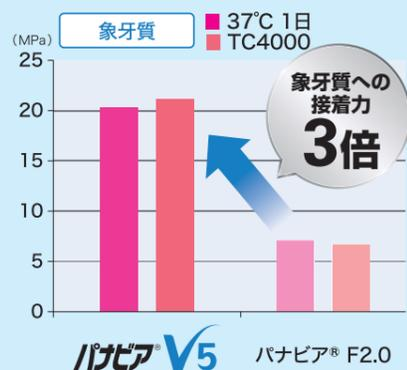
測定条件: 牛歯#1000研磨面、被着面積3mmΦ、化学硬化、37℃水中に1日浸漬後(37℃1日)、または、サーマルサイクル後(4-60℃、4000回:TC4000)、測定装置: オートグラフ AG-100kN(島津製作所)クロスヘッドスピード: 2mm/min
